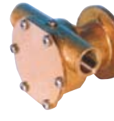
16.00137 ST137 Bocche da 3/8, portata lt./min. 13/28 per motori Nanni FK2/ FK3, Aifo, Mitsubishi.
