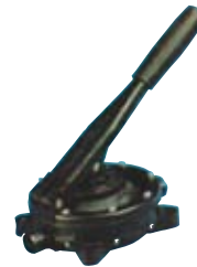
16.16029 Pompa a membrana in plastica, viteria inox, membrana in neoprene, portata 30 lt./min., portagomma Ø mm. 25.
