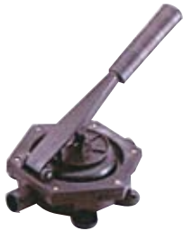
16.16029 Pompa a membrana in plastica, viteria inox, membrana in neoprene, portata 30 lt./min., portagomma Ø mm. 25.
