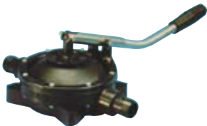
16.16033 Pompa a membrana, portata 35 lt./minuto, capacità di pompata lt. 0,65, aspirazione mt. 3,5, mandata mt. 5,5, portatubo Ø mm. 30.
