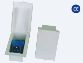
39.39235 Spina 16A ad incasso a filo a due poli più terra, in materiale termoplastico bianco, con contatto di protezione e sportello a scatto di chiusura; foro d'incasso, mm. 70x135x65 profondità
