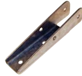
29.30007 Cavalotto in acciaio inox per fissare la scaletta alla plancetta in vetroresina. Lunghezza mm. 140. Adatto per tubo Ø mm. 22-25.
