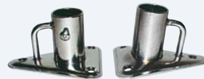
Base in acciaio inox per candelieri Ø mm. 25. Dim. base mm. 76 x altezza mm. 89. 29.30064 dritta 29.30065 inclinata di 6°
