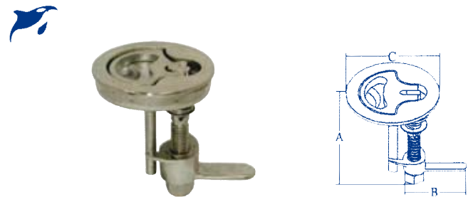
50.50139 Sistema di chiusura a vite che, tramite rotazione della maniglia, permette di bloccare il pagliolo evitando qualsiasi vibrazione. Dim. mm. A=96, B=68, C=78.
