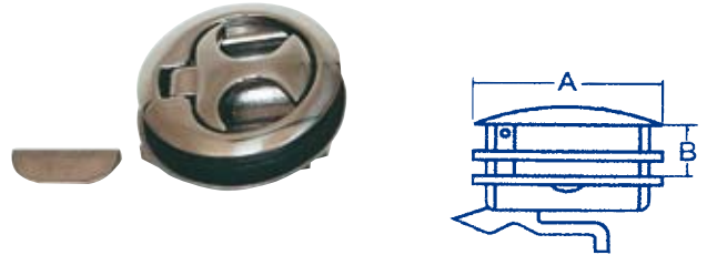
50.50130 con maniglia a molla e fermo a scatto. Foro incasso Ø mm. 50. Dim. mm. A=61, B=12-17.
